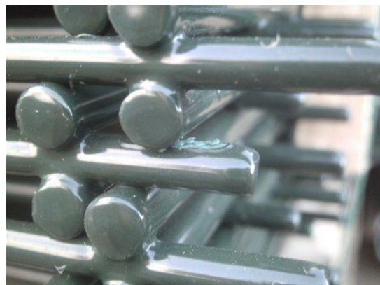
Lakschade door verschuiven van de pakken
