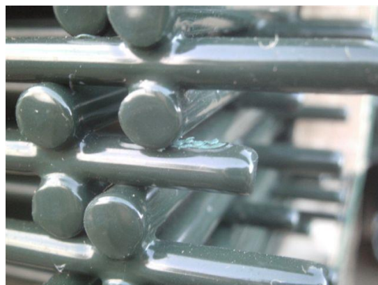
Uszkodzenie farby spowodowane przesunięciem skafandra
